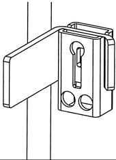
3. Dübel einsetzen und Riegelrohr durch eine der unteren Bohrungen anschrauben, siehe Abb. 2.
