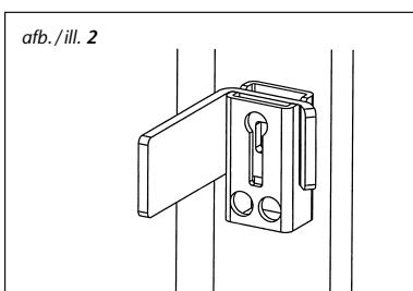
3. Breng de pluggen aan en bevestig de houder alleen met de onderste schroef (afb. 2).
