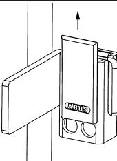
6. Riegel einsetzen und einrasten lassen.
