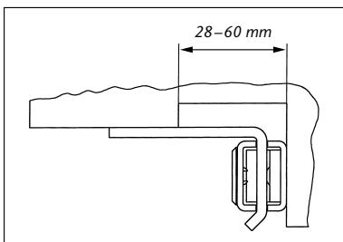
De ABUS SW 20 zorgt voor een doeltreffende beveiling van naar binnen draaiende ramen en deuren en draai/keip, en wordt bij smalle kozijnen (min. 28mm / max. 60mm) direct op de muur gemonteerd.
